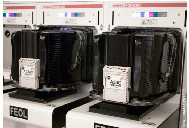
Dort werden die Siliziumscheiben übereinander und voneinander getrennt abgelegt. Innerhalb der Maschine entnehmen und bestücken kleine Roboter die FOUPs. Der Transport der FOUPs zwischen den einzelnen Maschinen läuft über ein System an der Decke, das die FOUPs aufnimmt, transportiert und in der nächsten Maschine oder im Zwischenlager absetzt.
