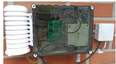
Abb 3: Test-Wetterstation. (Funkte aktuell die Daten über ein WLAN-Netz an die „openSenseMap“. ( https://opensensemap.org ))
